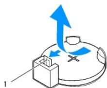
1 leva di sblocco della batteria
